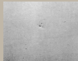
防錆不良によるピンホール模様 Pinhole texture by inappropriate rust proof.
